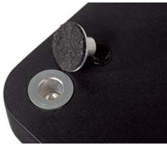
Le découplage des enceintes sur les supports s'effectue par un jeu de petites pièces en aluminium avec feu-trine reposant sur une bille encastrée.
